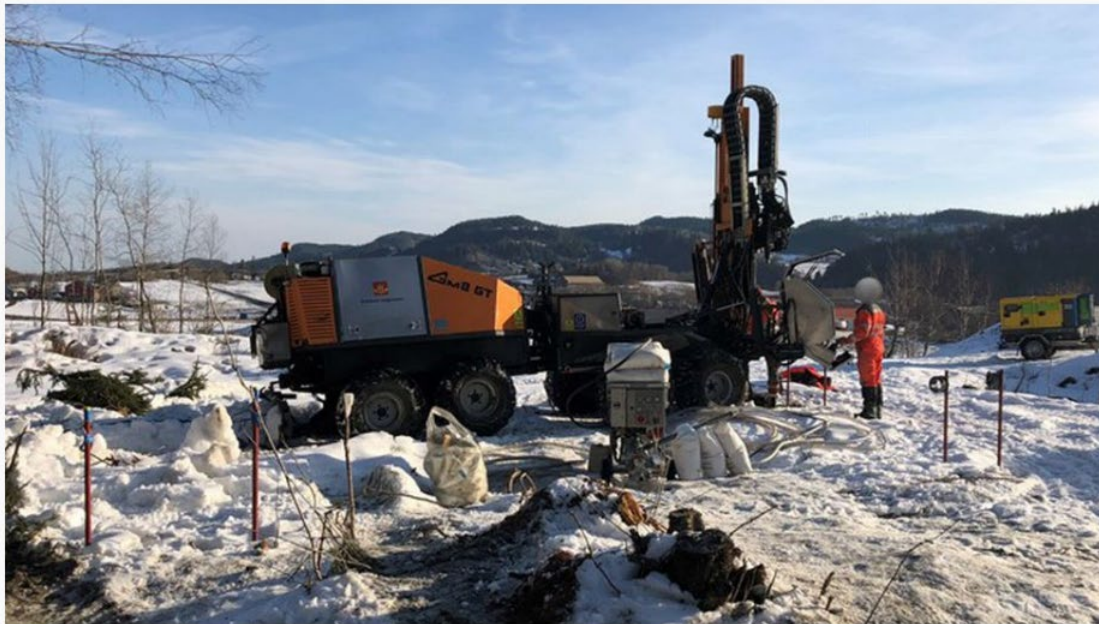
Under forsøket ble det brukt en borerigg for geologiske undersøkelser til å bore hull og fylle dem med salt. FOTO: PRIVAT
